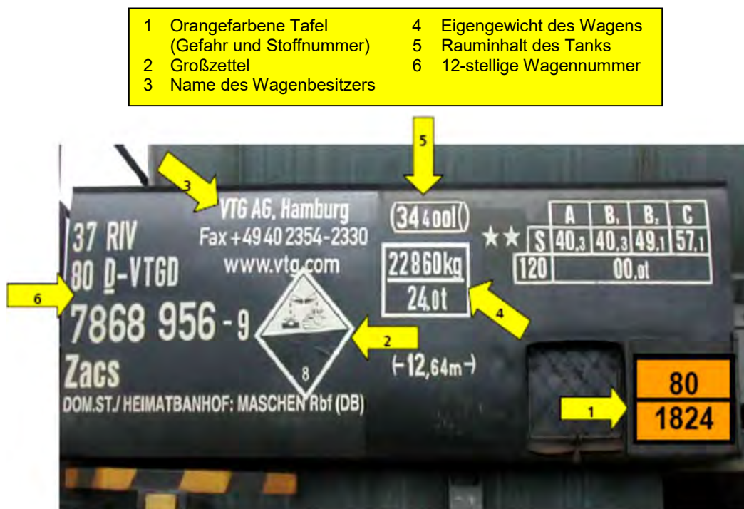
Abbildung 57 - Aufschriften an einem Gefahrgutkesselwagen
