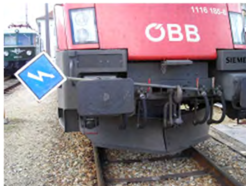
Abbildung 27 – Signal „An die Vorheizanlage angeschlossen“
