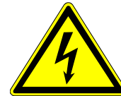
Abbildung 25 – Gefahr durch unter Spannung stehende Anlagenteile (KennV)
